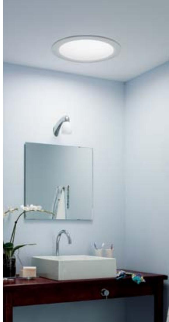
Le Sun Tunnel est la solution pour acheminer la lumière naturelle dans les salles de bains situées au cœur de la maison, même si celles-ci sont éloignées du toit. Ce conduit de lumière transmet efficacement la lumière jusqu'à 6 mètres.
