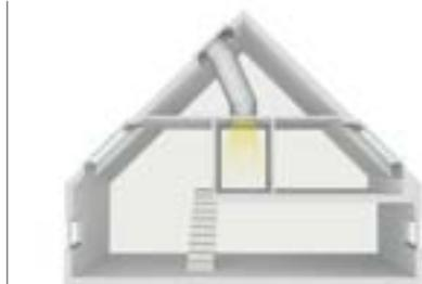
Un conduit doté d'un revêtement intérieur hautement réfléchissant transporte la lumière naturelle jusqu'à 6 mètres de distance. Cette solution s'installe dans toutes les pièces sombres, à l'étage comme au rez-de-chaussée.
