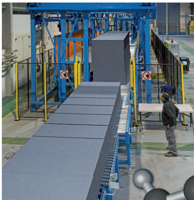
**Le calibrage très précis et la surface plus lisse des panneaux isolants sont particulièrement appréciables en ITE sous enduit mince.**
