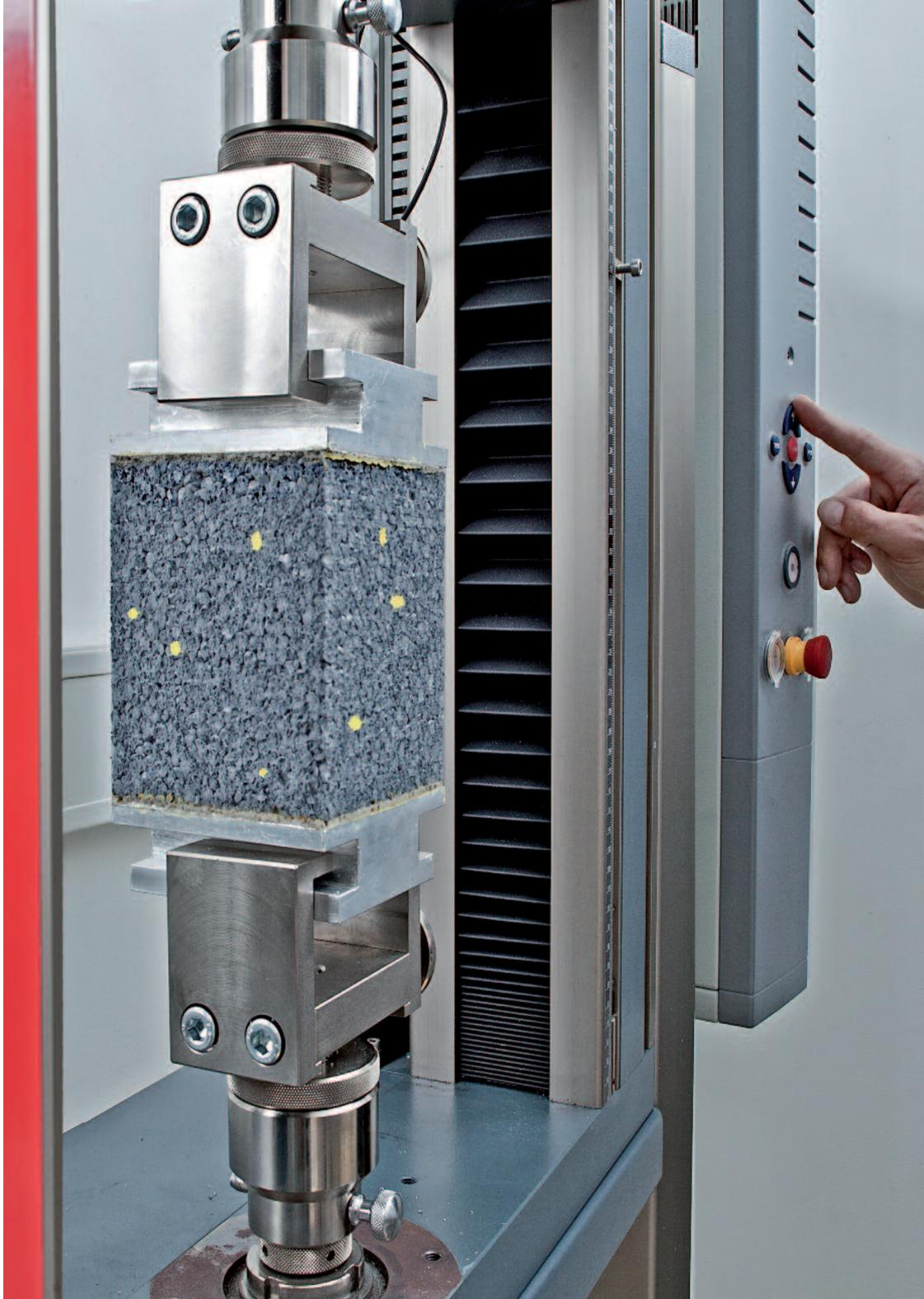
**Ci-dessus :** la mesure de traction perpendiculaire permet de valider la cohésion du PSE. Très rigoureux, le cahier des charges du Sto-Panneau Top31 va bien au-delà des exigences réglementaires pour garantir précision de découpe, tolérances minimales et stabilité dimensionnelle à long terme.
